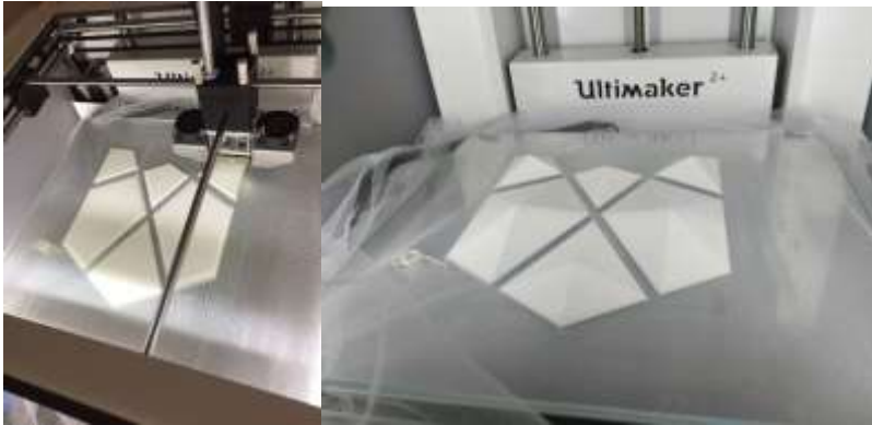
Görsel 13. Ultimaker 2+ üç boyutlu yazıcıda PLA ile basılmış konik parçalar, Tasarım:2
