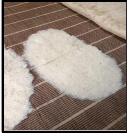
Resim 6. Tepme işlemi için hazırlanmış sikke kalıpları
