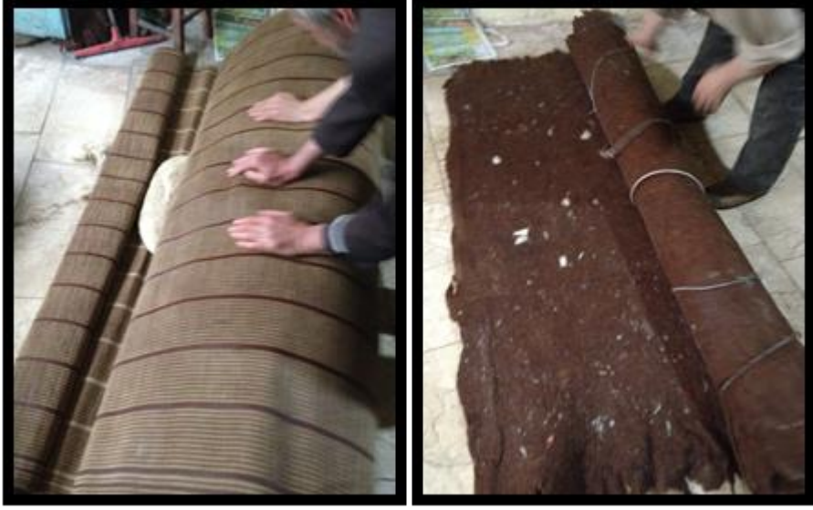
Resim 8. Rulo yapma ve rulonun kalıpgöçe geçirilmesi işlemi
