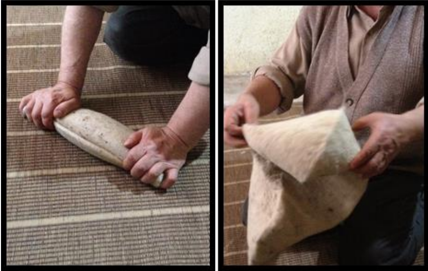
Resim 14. Elle tepme ve kat açma işlemi
