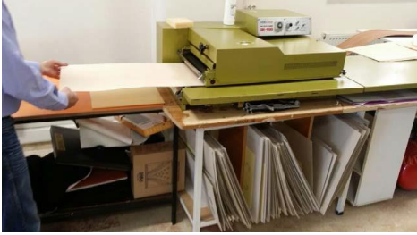
Resim.11(solda)-Akçaağaç yüzeyinin tela ile kaplanması
