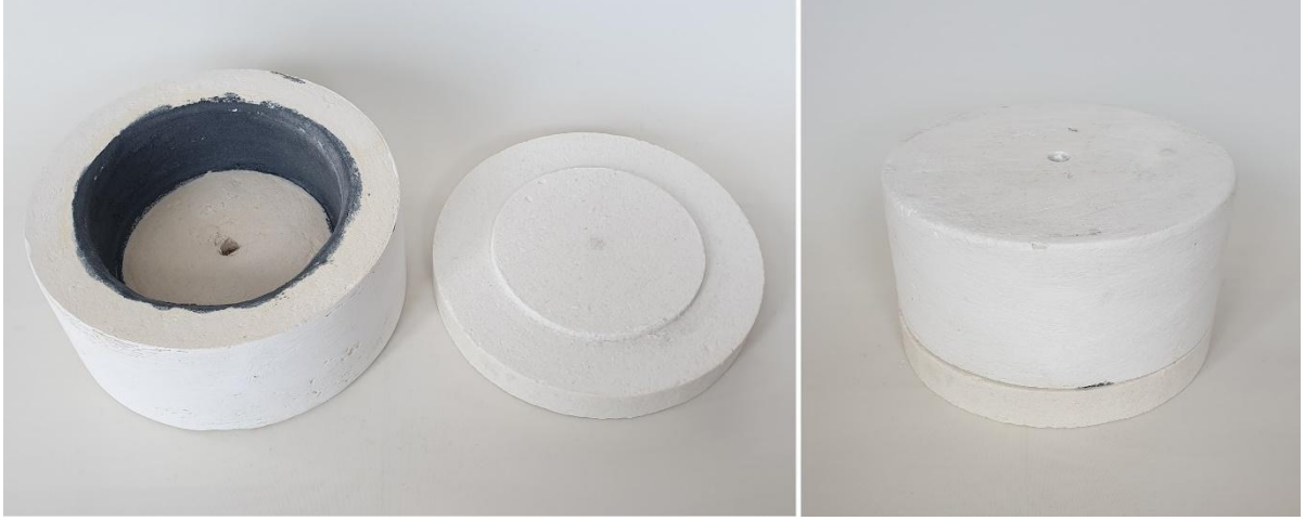
Resim 1. Mikroda Fırın içerisinde yerleştirilen Füzyon Fırınlar (Fuseworks Microwave Kiln) (Genç, 2023: 94).
