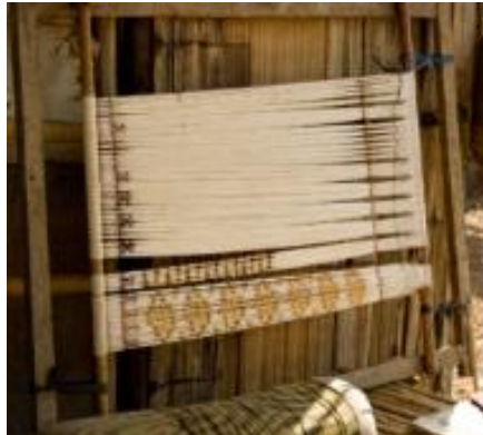
Resim 9. Çözgünün çekildiği çerçeve (Buckley, 2012: 4)
