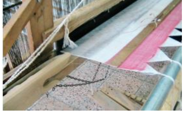
Resim 5.B Kamçı mekanizması (Başaran, 2018: 16).
