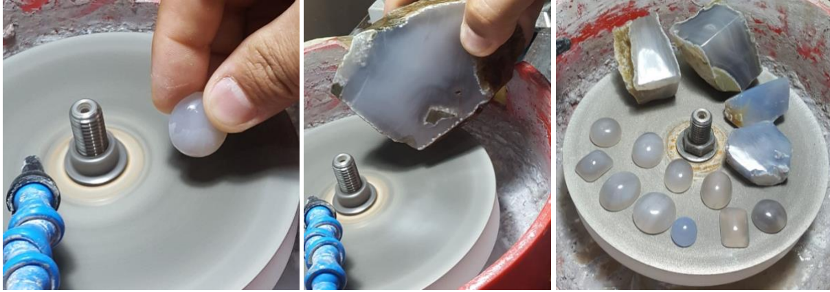
Görsel 9: Soldan sırasıyla; günümüzde yuvarlak formda kabaşon işlenmiş süstaşı ile dilimlenmiş süstaşı yüzünün yatay keçe disk üzerinde cilalanması ve cila işlemi bitmiş farklı formlarda kabaşon işlenmiş süstaşı örnekleri
