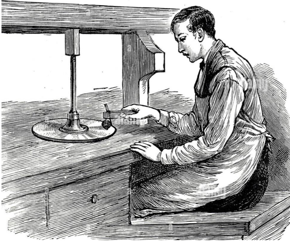
Görsel 8: 19. yy. süstaşını yatay disk üzerinde cilalama işlemini gösteren bir gravür (www.alamy.com; Url, 12).
