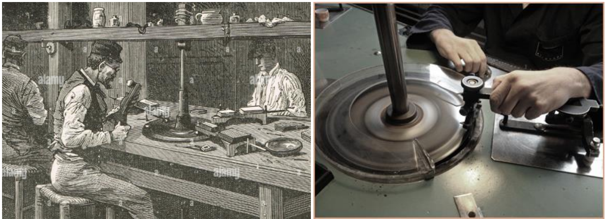
Görsel 6: Solda bir başka süstaşı faset işleme atölyesine ait gravür görseli (Wood, 1873; Gravür Jules Féart; www.alamy.com; Url 10) ile sağda günümüze ait modern süstaşı faset işleme tezgâhı (www.aarachminov.com; Url 11).
