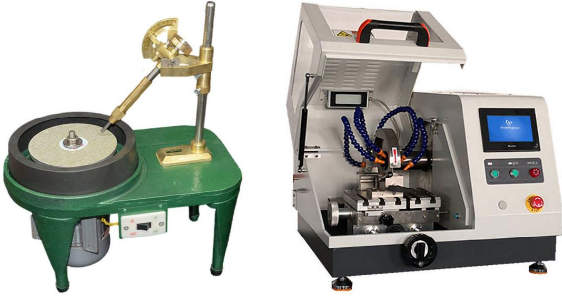
Görsel 3: Solda modern istenilen açıda süstaşı/mücevher yatay yönde faset kesme, şekil verme makinesi (Url 4); sağda dikey yönde süstaşı/mücevher faset kesme, dilimleme testeresi (Url 5); (https://turkish.alibaba.com).
