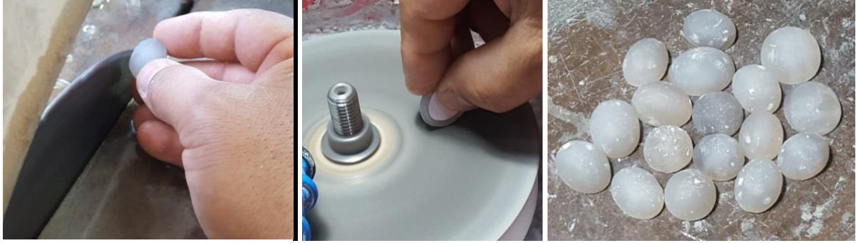
Görsel 7: Solda sırasıyla süstaşının kesimini ve kaba formu oluşturmak için dikey yönlü elmas uçlu testere, ortada yüzeyi elmas tozlarıyla kaplı yatay yönde aşındırıcı disk, sağda ise parlatma ve cilalama aşamasına gelen farklı formlarda kabaşon işlenmiş süstaşı örnekleri
