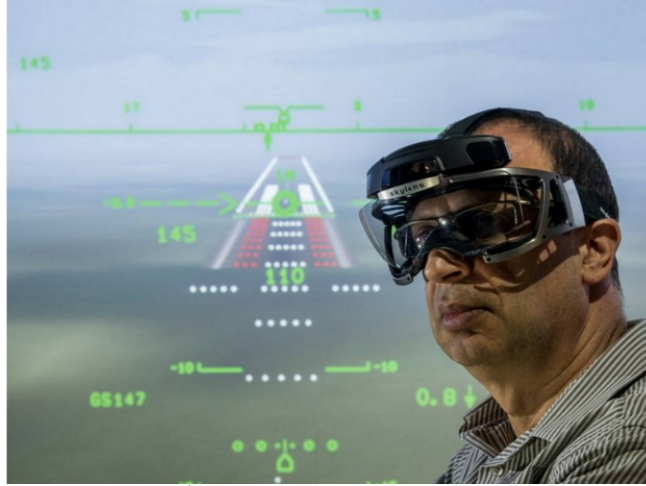
Şekil 6. Bir Pilot İçin Kullanılan Artırılmış Gerçeklik Görüntüsü.
