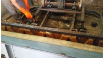
Fotoğraf 12. Sulanan ve sabunlanan keçenin pişirilmesi - Erkuş Keçe Atölyesi - Afyonkarahisar
