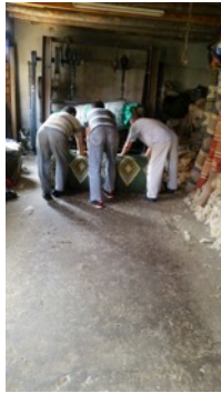
Fotoğraf 7. Sarıldıktan sonra birkaç kez yuvarlanan yün - Erkuş Keçe Atölyesi - Afyonkarahisar
