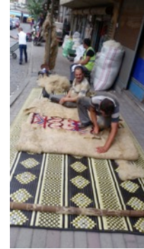
Fotoğraf 9. Hasıra sarılan yünün tepme makinesinde dövülmesi - Erkuş Keçe Atölyesi - Afyonkarahisar
