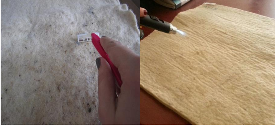
Resim 4. Jiletle Temizleme Ve Pürmüzle Yakma Bitim İşlemleri
