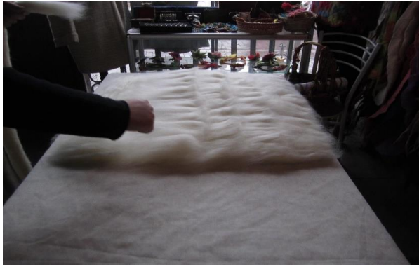
Resim 1. Desensiz keçe için yünün hasır üzerine serilmesi işlemi
