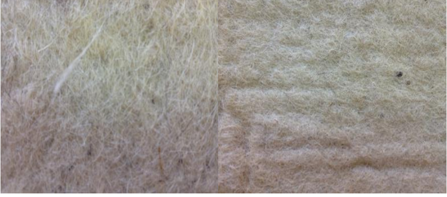
Resim 7. Bitim işlemi uygulanmamış ve pürmüz ile yakma bitim işlemi uygulanmış keçe
