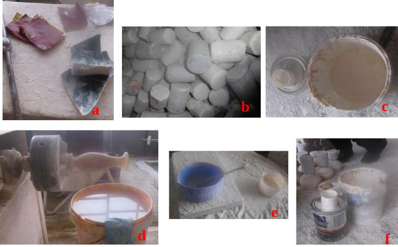
Resim 2. Oniks taşından ürünlerin yapımında ve süslemesinde kullanılan gereçler (a.zımpara, b.silindirik takoz, c.akeme, d.asit-kalay karışımı, e.taş tozu, f. hızlandırıcı) Arı Oniks Atölyesi, 2015
