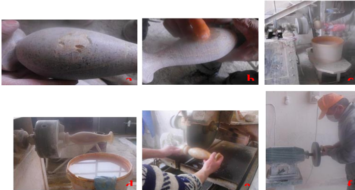
Resim 3. Oniks taşı ürünlerinde kullanılan süsleme teknikleri (a.Gözenekli ürün, b. kapatma tekniği uygulaması, c.zımparalama, d. parlatma, e. yıkama- kesme tekniği, f. düzeltme tekniği) Arı Oniks Atölyesi, 2015
