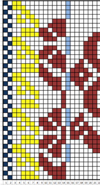
Çizim 8: Tasarlanan örneğin armür planı
