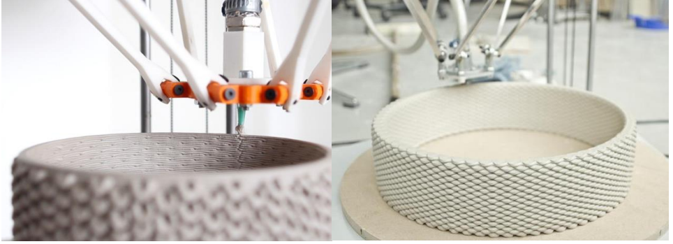
Resim-7: Oliver van Herpt, Harç Yığma (FDM) Baskı süreci ( http://oliviervanherpt.com/3d-printing-ceramics/ )
