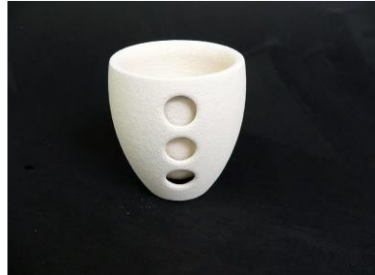
Resim-1 SLS Makinesinde Seramiğin Üretilmesi (Huson. 2011:5)
