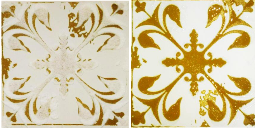
Şekil 6. Salbaş Kil Boyar Maddesinin 1060°C Vetroza Frit Denemesi, Pişirim Öncesi Ve Sonrası
