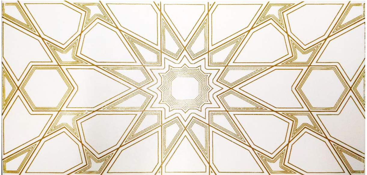
Şekil 13. Salbaş Kili Boyar Maddesinin 1192°C Serigrafi Baskı Tekniğiyle Selçuklu Deseni Uygulama Çalışması
