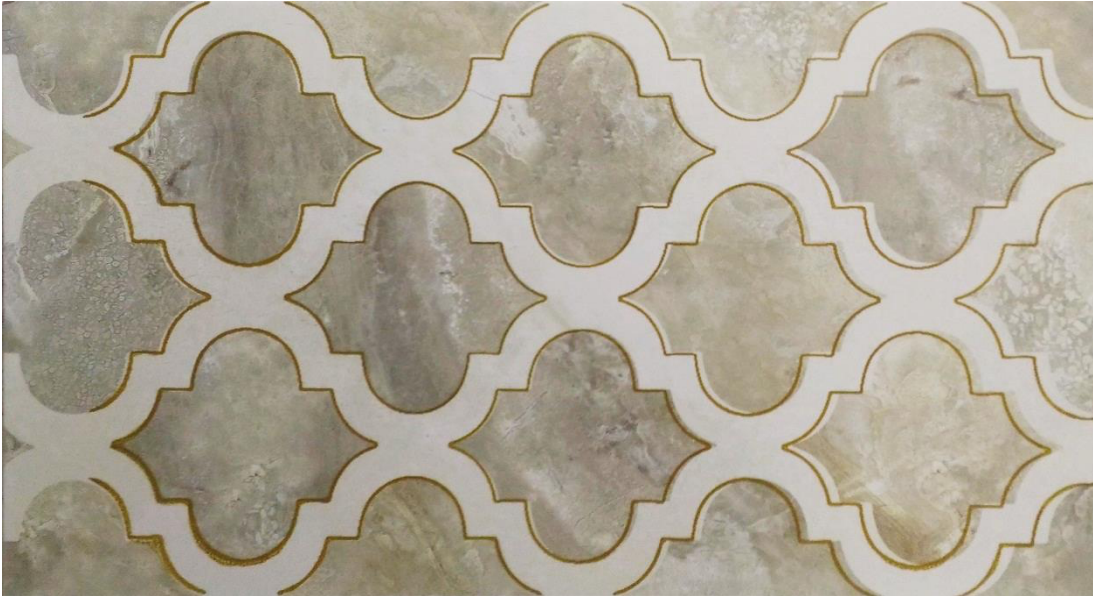
Şekil 11. Salbaş Kil Boyar Maddesinin 1192°C Dijital Baskı Tenklojisi Sonrası Kontür Uygulama Çalışması
