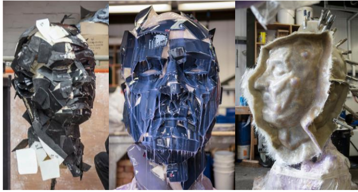
Görsel 17. “Otoportre” çalışmasının 3 boyutlu baskı teknolojisi ile somutlaştırılması ve kalıp aşaması.
