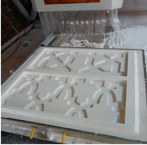
Resim 12. CNC tezgahlarında Katı Modelleme Aşaması, Kubat Seramik Mak. Ltd.Şti., 2015
