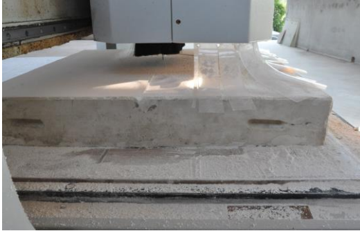
Resim 10. CNC tezgahlarında Alçı Bloğun Tezgaha Sabitlenmesi, Kubat Seramik Mak. Ltd.Şti., 2015
