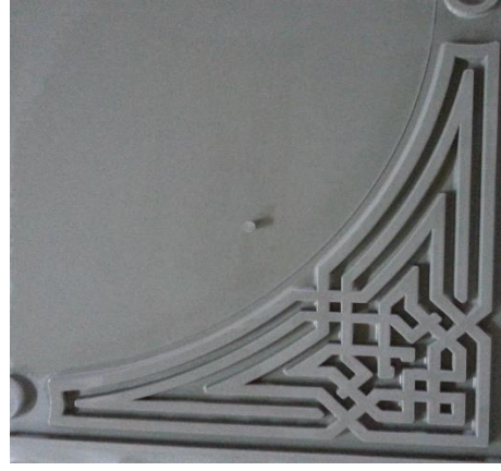
Resim 15. CNC'de Üretilmiş Kurumaya Bırakılmış Seramik Ürünler, Kubat Seramik Mak. Ltd.Şti., 2015
