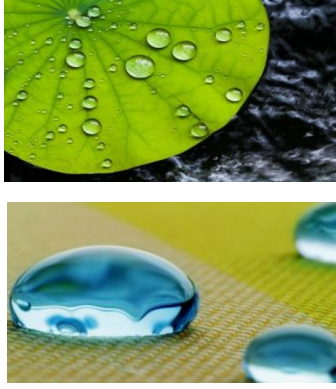
Resim 8: Lotus yaprağı ve Mincor TX TT ile kaplanmış polyester kumaş üzerindeki su damlacıkları (URL 11, 12)
