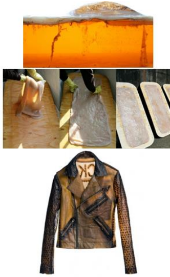
Resim 9: Biocouture üretim aşamaları (URL10)
