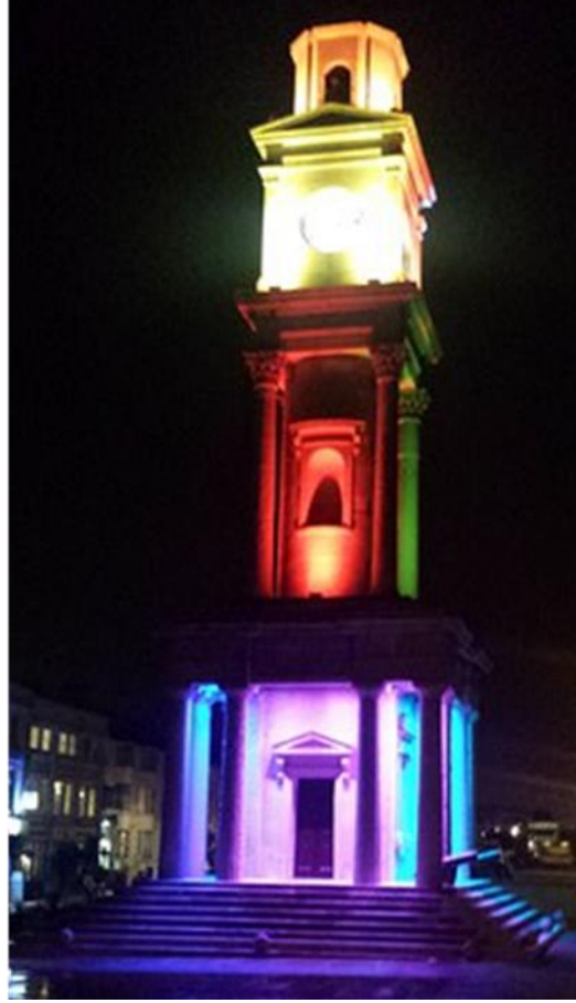
Resim 3.11 Renkli Kinetik ampullerle her bölümün farklı farklı aydınlatılması (Philips Color Kinetics, 2017:1-3)
