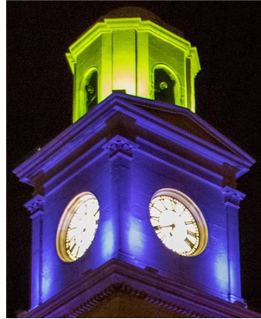
a) Deniz alçalırken (cezir)- kırmızı b) Deniz kabarıırken (met)-yeşil Resim 3.12. Kulenin en üst bölümünün gel-git durumuna göre aydınlatılması (Philips Color Kinetics, 2017:1-3)
