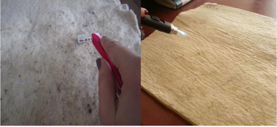
Resim 4. Jilette Temizleme Ve Pürmüzle Yakma Bitim İşlemleri
